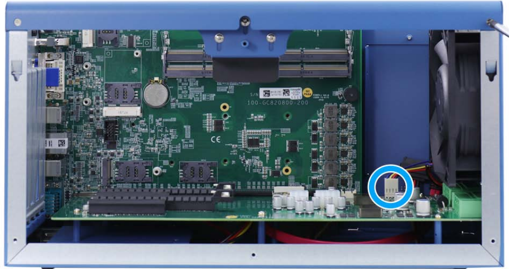
Remove 4-pin fan connector
