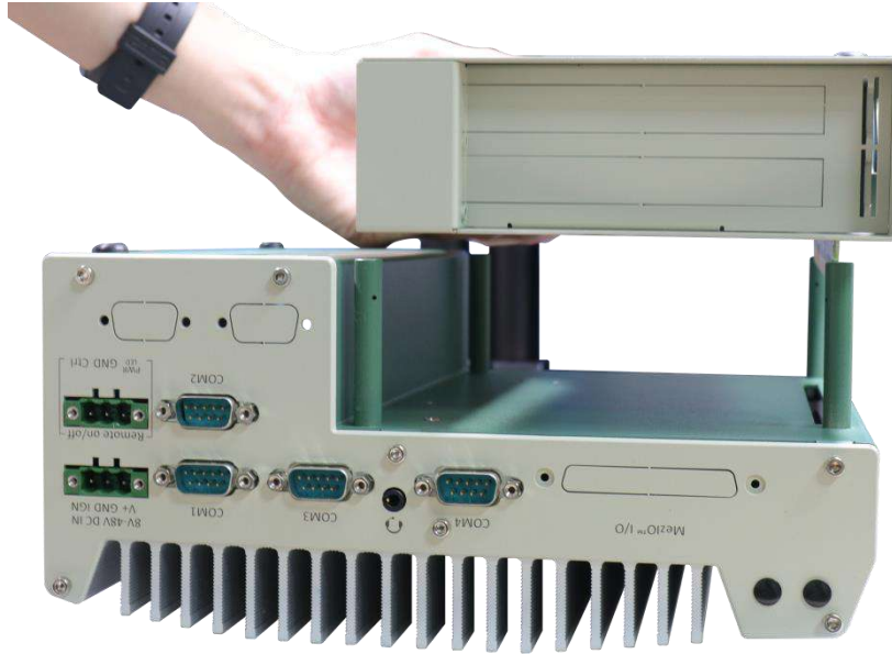
Install the Cassette module
